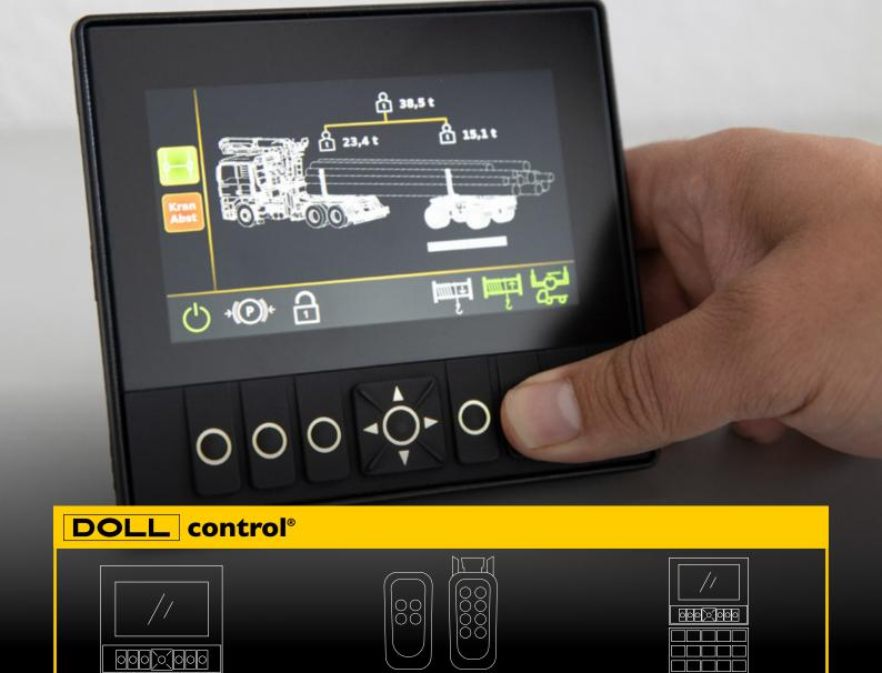
Bedientableau + Funkfernsteuerung DOLL connect®
